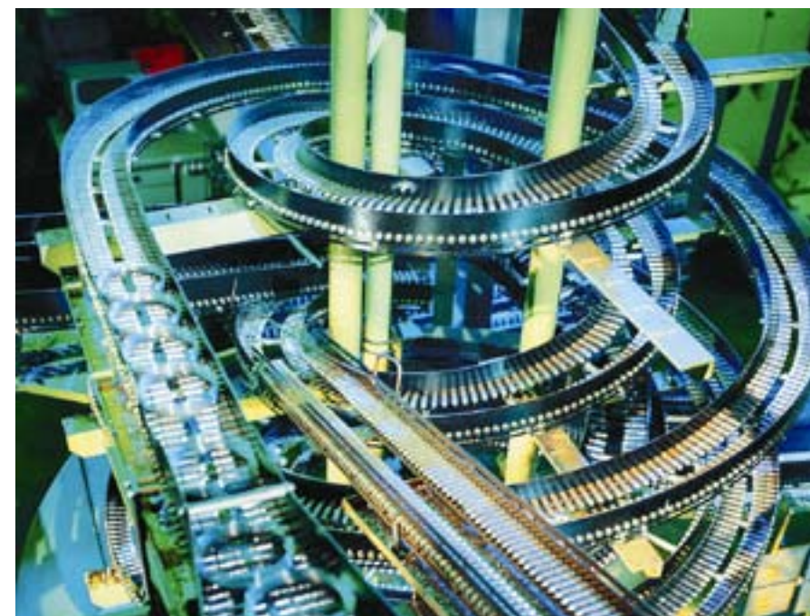
Automação: sistema de transporte de peças desenvolvido pela Siemens é utilizado na indústria automobilística
