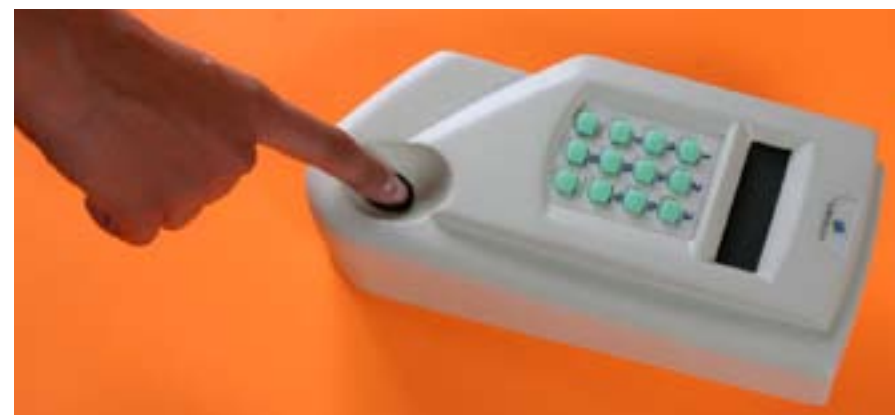
Leitora de impressões digitais e algoritmo de reconhecimento em ação (abaixo): 35 mil impressões rastreadas por segundo
