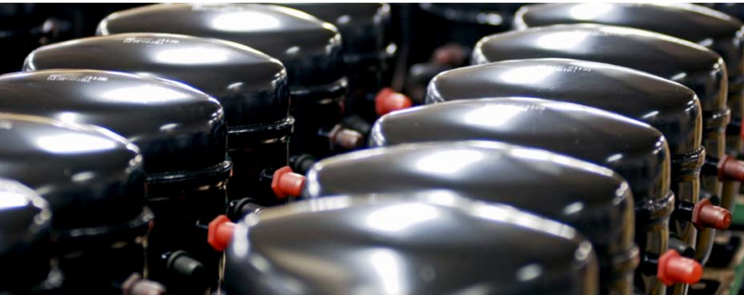
Compressores para refrigeração: mesma quantidade de frio gerada com apenas metade da energia de 20 anos atrás
