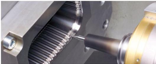
Usinagem fina e óptica para desenvolvimento de tecnologias para a produção e processamento de **componentes de alta precisão** (lentes, moldes, componentes para a indústria de semi-condutores etc.).
