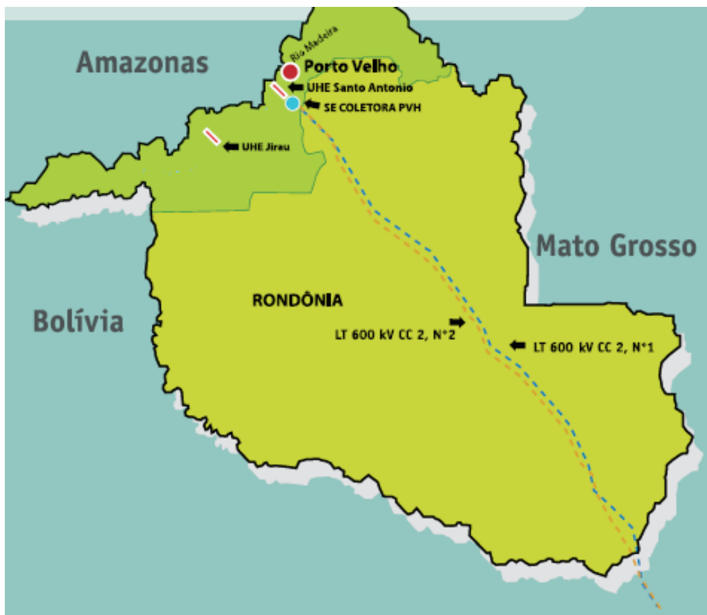
FIGURA 7 - DETALHE DAS LINHAS DE TRANSMISSÃO EM RONDÔNIA
