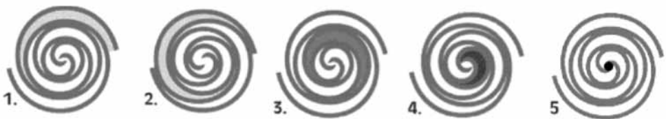
Figura 3.20 - Processo de compressão em um compressor Scroll
