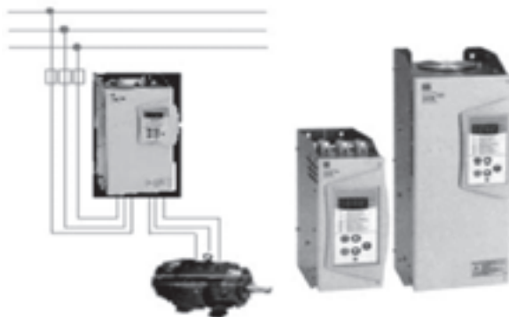
Figura 29 – Partida com soft-starter
