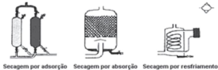
O ar comprimido pode ser secado de três maneiras diferentes. Confira a seguir.
