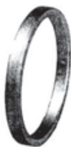
O tipo do formato geométrico do anel de desgaste depende do projeto da bomba e do líquido bombeado. Em casos especiais, o fabricante pode fornecer um anel de desgaste projetado especialmente para o caso.
