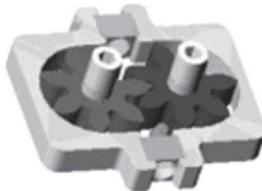
**Figura 10 – Bomba rotativa de engrenagem em corte transversal**
