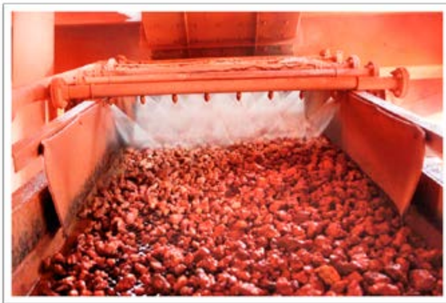
A lavagem da bauxita é feita, exclusivamente, com água. Crédito: João Ramid
