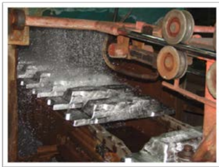
Água utilizada para o resfriamento de lingotes de metal primário na área de fundição. Crédito: Albras
